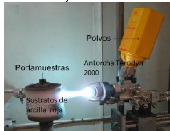
Figura 1. Imagen del porta-muestras y de antorcha Terodyn 2000™
